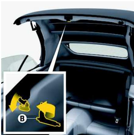
Fig. 57 : Déploiement du crochet de verrouillage
