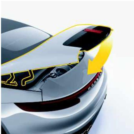
Fig. 59 : Fermeture du capot de puits de capote
