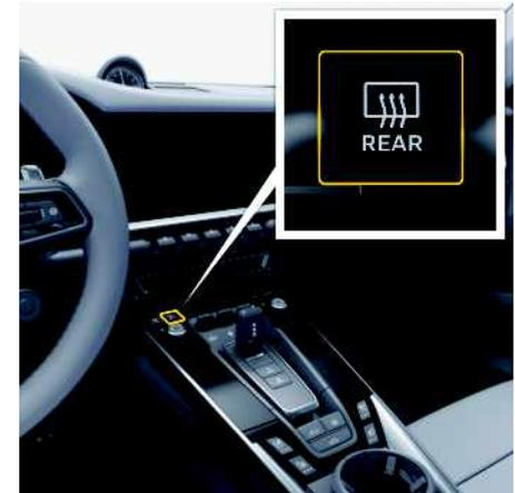
Fig. 77 : Touche dégivrage de la lunette arrière / des rétroviseurs extérieurs
