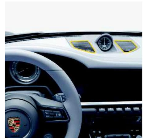
Fig. 74 : Réglage de la zone de ventilation supérieure
