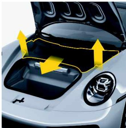
Fig. 80 : Dégagement et soulèvement du cache en plastique
