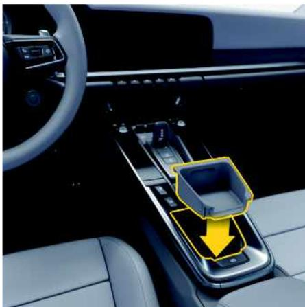
Fig. 187 : Mise en place et retrait du coffre de rangement
