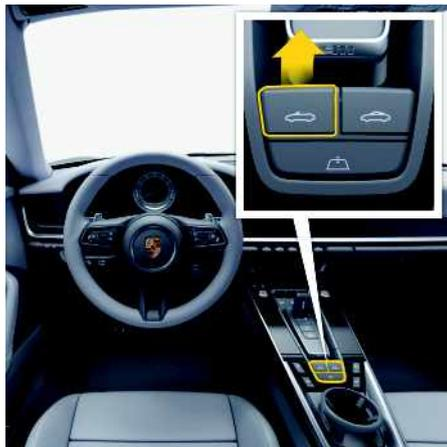
Fig. 38 : Ouverture de la capote avec la touche
