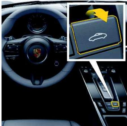
Fig. 220 : Fermeture du toit Targa avec la touche
