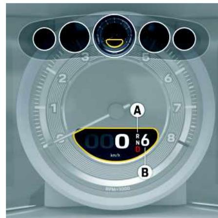
Fig. 23 : Affichage du mode de fonctionnement et du rapport engagé
