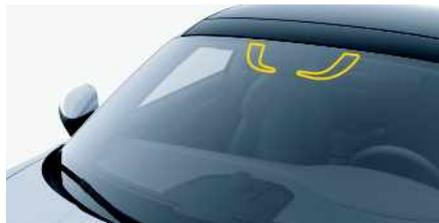
Fig. 120 : Fixation des appareils de péage
