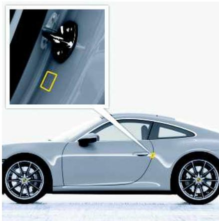
Fig. 123 : Plaque d'indication de pression de gonflage des pneumatiques
