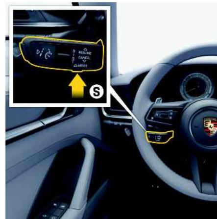
Fig. 110 : Levier de commande des systèmes d'assistance à la conduite
