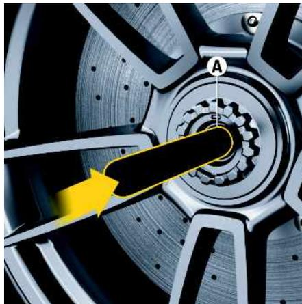
Fig. 135 : Desserrage de l'axe de sécurité
