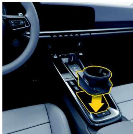
Fig. 176 : Mise en place du porte-gobelet dans la console centrale
