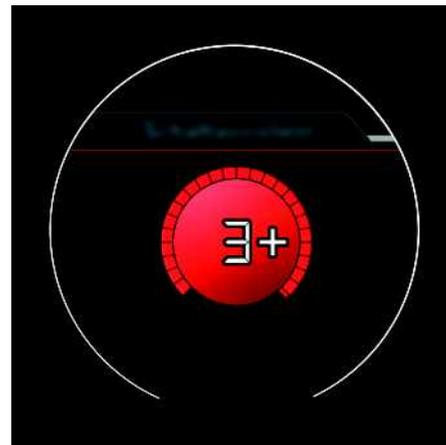
Fig. 29 : Exemple de recommandation de changement de rapport
