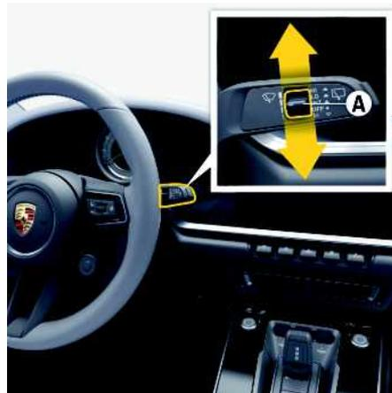
Fig. 104 : Commutateur du capteur de pluie / mode intermittent
