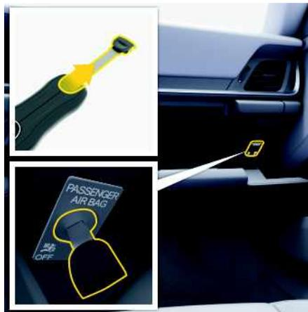
Fig. 246 : Désactivation de l'airbag passager
