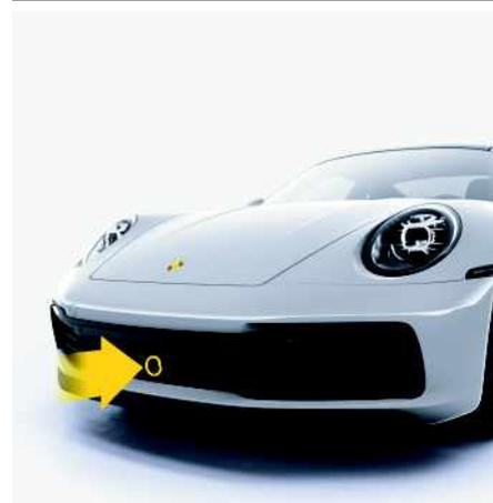
Fig. 193 : Position du capteur radar
