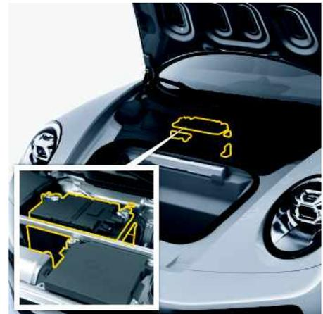
Fig. 19 : Batterie au plomb
