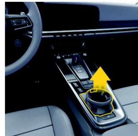
Fig. 177 : Retrait du porte-gobelet dans la console centrale
