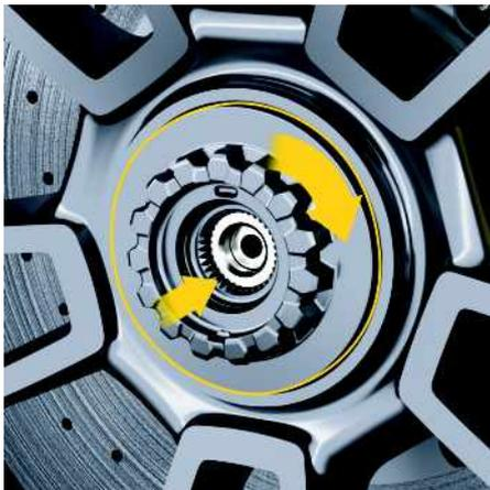
Fig. 142 : Vissage de la vis centrale
