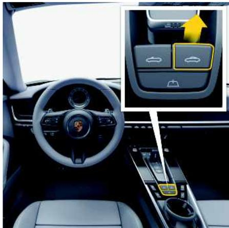
Fig. 39 : Fermeture de la capote avec la touche
