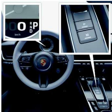
Fig. 24 : Activation du verrouillage de parking
