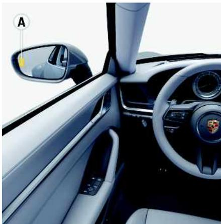
Fig. 8 : Indicateur A dans le rétroviseur extérieur
