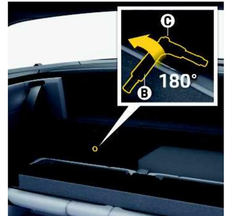
Fig. 223 : Dépressurisation du mécanisme du toit
