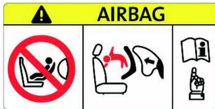
Fig. 247 : Autocollant d'avertissement airbag
