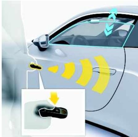
Fig. 272 : Ouverture et fermeture des vitres avec la clé du véhicule
