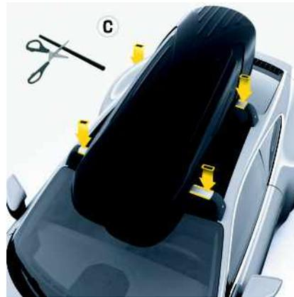
Fig. 244 : Découpe et montage des profilés
