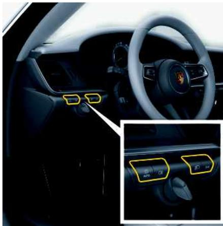
Fig. 96 : Panneau de commande de l'éclairage
