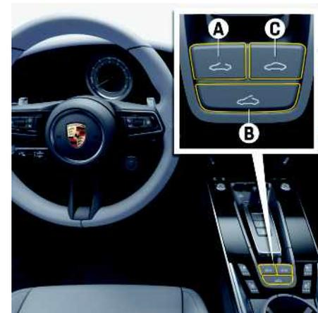
Fig. 261 : Utilisation du toit ouvrant en acier
