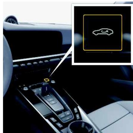
Fig. 75 : Activation / Désactivation du recyclage de l'air
