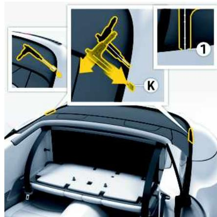
Fig. 48 : Insertion de la clé d'actionnement de secours
