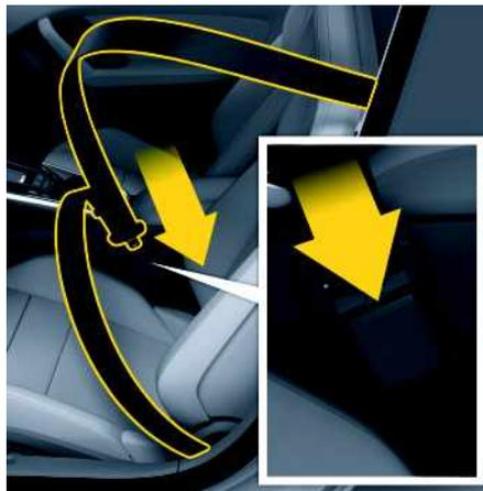
Fig. 62 : Mise en place de la ceinture de sécurité
