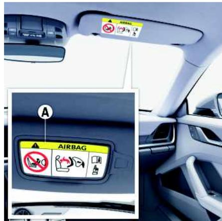
Fig. 248 : Autocollant d'avertissement airbag sur le pare-soleil
