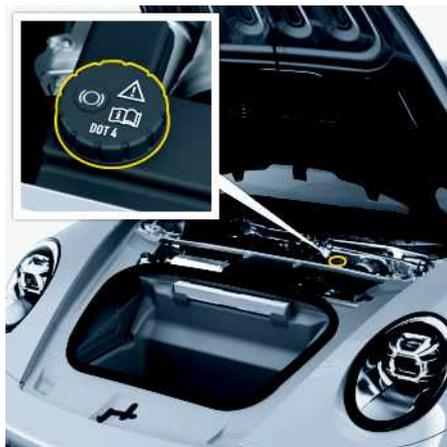
Fig. 115 : Réservoir de liquide de frein
