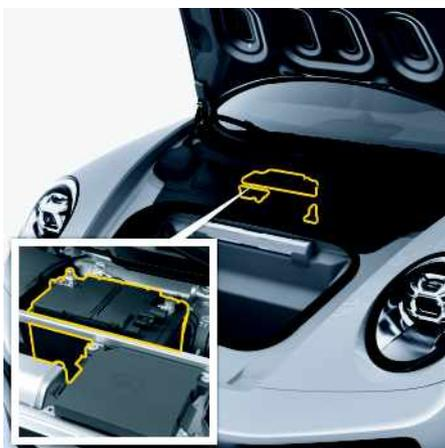
Fig. 21 : Batterie au lithium
