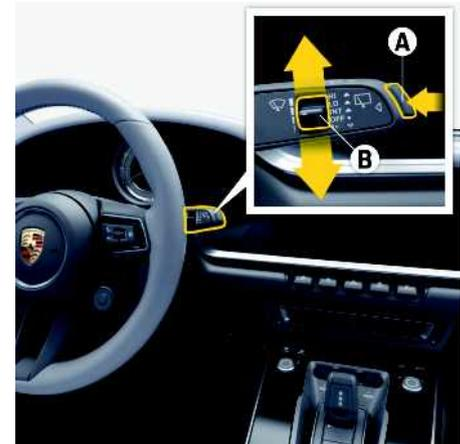
Fig. 102 : Commutateur du capteur de pluie/mode intermittent et essuie-glace arrière
