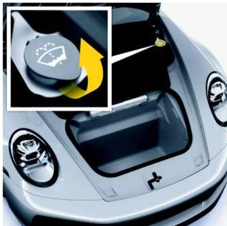
Fig. 117 : Réservoir de liquide lave-glace pour pare-brise
