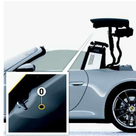
Fig. 229 : Retrait du bouchon au niveau de l'accès pour l'actionnement de secours du verrouillage de toit
