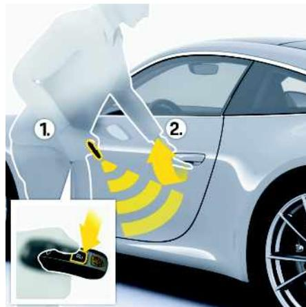
Fig. 265 : Déverrouillage des portes à l'aide de la clé du véhicule
