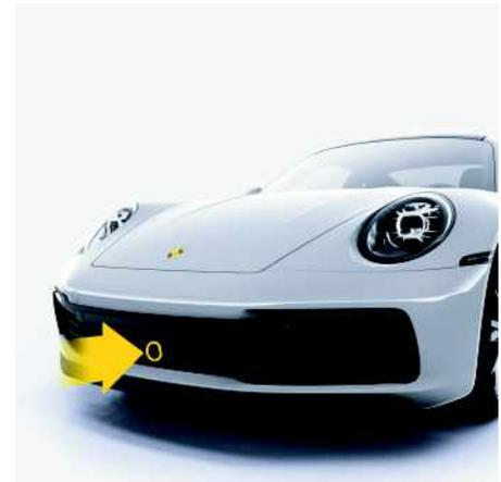
Fig. 164 : Position du capteur radar
