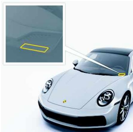
Fig. 276 : Emplacement du numéro d'identification du véhicule
