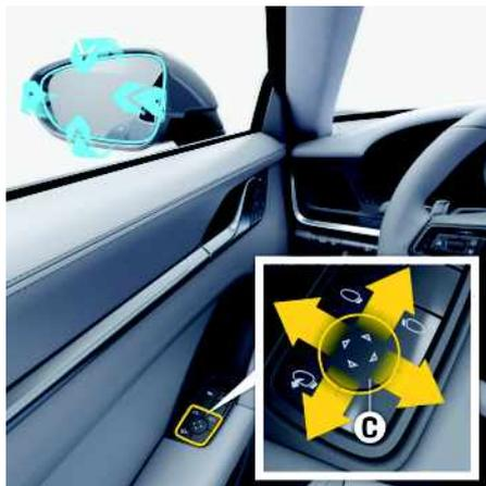
Fig. 204 : Réglage des rétroviseurs extérieurs
