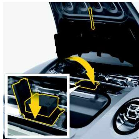
Fig. 83 : Mise en place du compresseur pour pneumatiques
