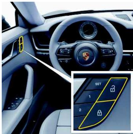
Fig. 267 : Touche de verrouillage centralisé dans la garniture de porte
