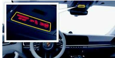
Fig. 252 : Indicateur PASSENGER AIR BAG OFF/ON
