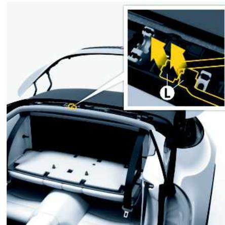
Fig. 52 : Débranchement des connecteurs L
