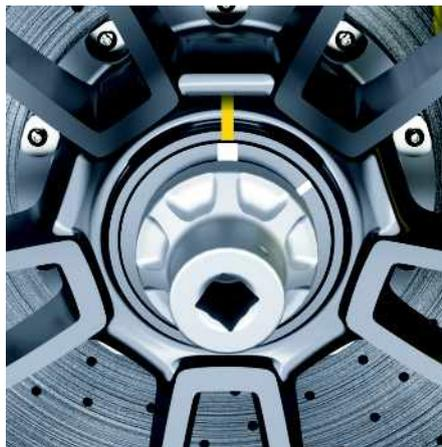
Fig. 151 : Serrage de la vis centrale
