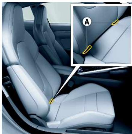
Fig. 253 : Ancrages ISOFIX du siège passager
