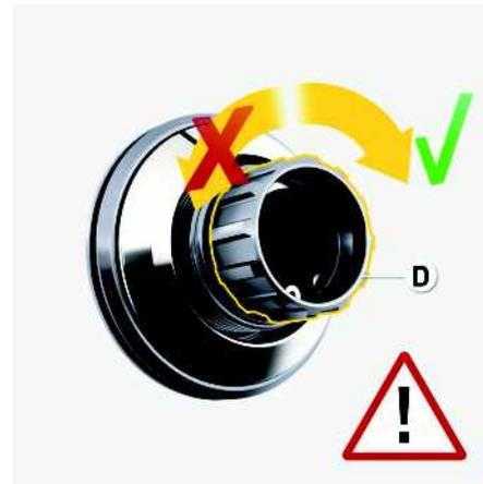
Fig. 138 : Contrôle de la protection anti-perte
