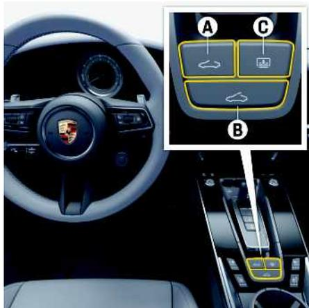
Fig. 262 : Utilisation du toit ouvrant en verre
