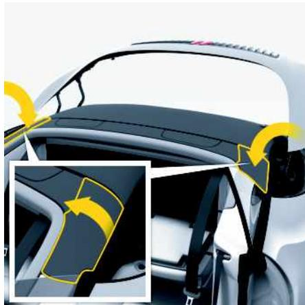
Fig. 54 : Enfoncement des volets latéraux arrière vers le bas
