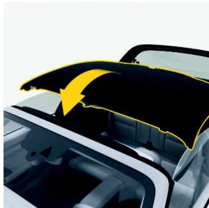
Fig. 231 : Déplacement de l'élément de capote vers l'avant
