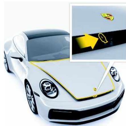
Fig. 33 : Déverrouillage du capot du coffre à bagages
