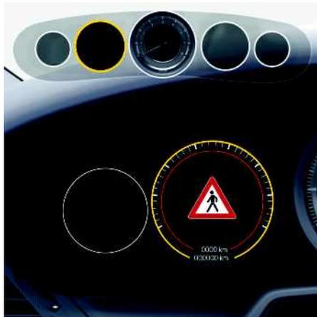
Fig. 31 : Avertissement piétons dans le combiné d'instruments
