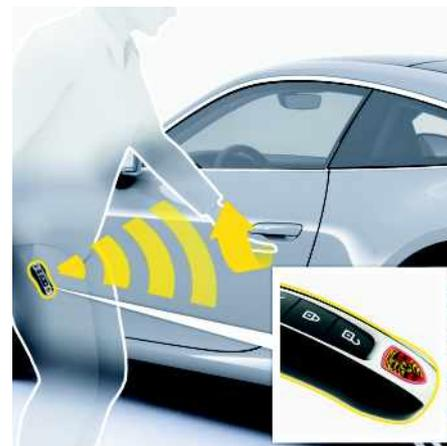
Fig. 266 : Déverrouillage de la porte avec le système accès Confort
