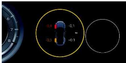
Fig. 124 : Exemple d'écart de pression
