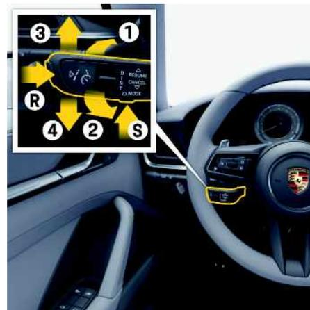
Fig. 169 : Levier de commande des systèmes d'assistance à la conduite
