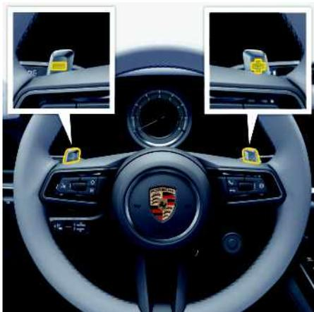
Fig. 26 : Volant avec palettes de passage de rapport
