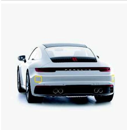
Fig. 9 : Capteurs radar dans le pare-chocs arrière
