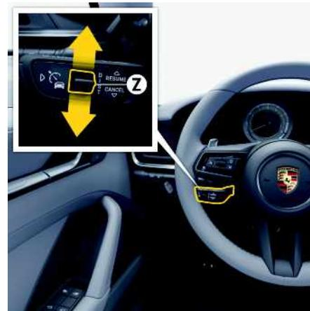
Fig. 199 : Réglage de la distance de régulation
