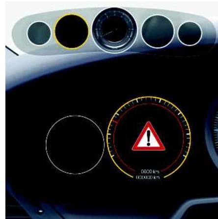
Fig. 152 : Avertissement de collision dans le combiné d'instruments
