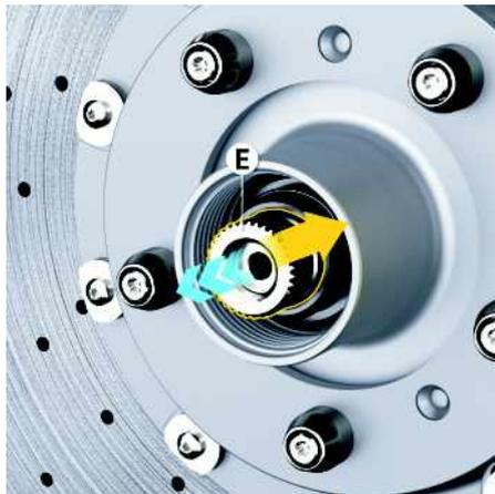
Fig. 139 : Contrôle de l'axe de sécurité
