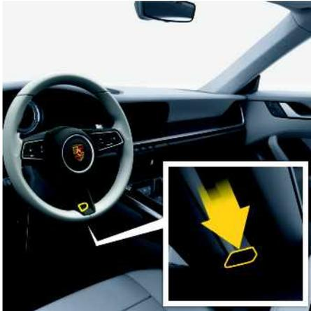
Fig. 275 : Touche de chauffage du volant
