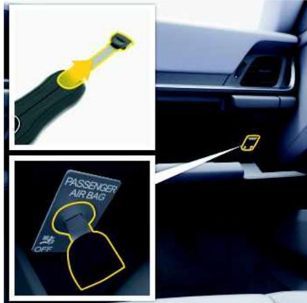
Fig. 251 : Désactivation de l'airbag passager
