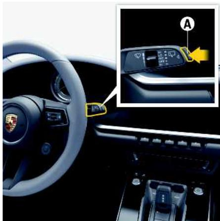
Fig. 105 : Commutateur de l'essuie-glace arrière
