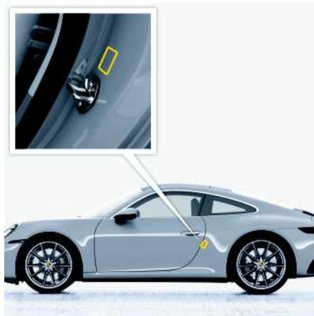
Fig. 277 : Emplacement de la plaque signalétique
