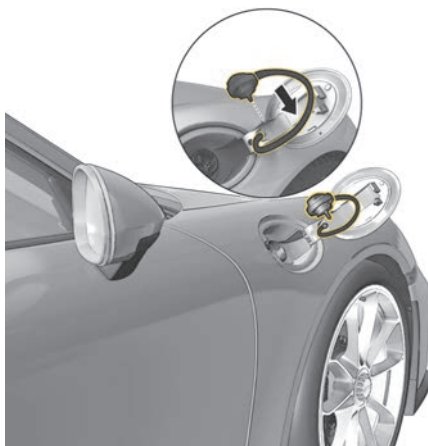
Fig. 177 : Ouverture du bouchon du réservoir
