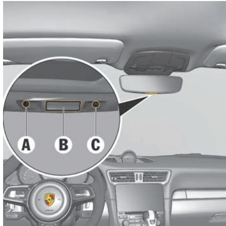
Fig. 186 : Réglage automatique anti-éblouissement rétroviseur intérieur – variante A
