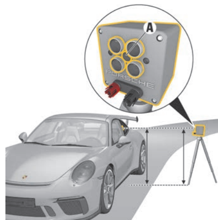
Fig. 122 : Mise en place de l'émetteur
