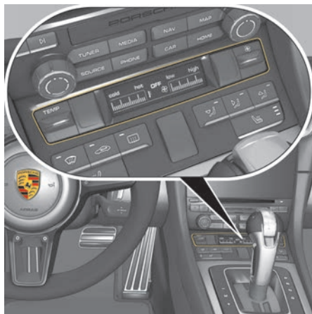
Fig. 30 : Panneau de commande du chauffage et de la ventilation
