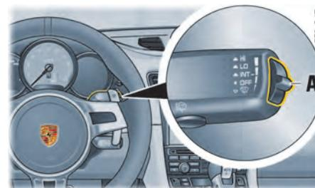
Commutateur de réglage de la sensibilité du capteur de pluie / mode intermittent (A)
