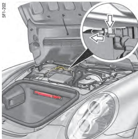
6. Repoussez vers le bas la languette sur le connecteur du capteur de batterie et débranchez le connecteur.
