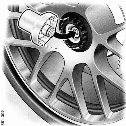
6. Positionnez la douille intercalaire et enfoncez-la **jusqu'en butée**. Cela permet de reculer le verrouillage de sécurité de la vis centrale.
