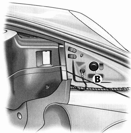
2. Retirez l'obturateur en caoutchouc **B** de l'ouverture de déverrouillage.
