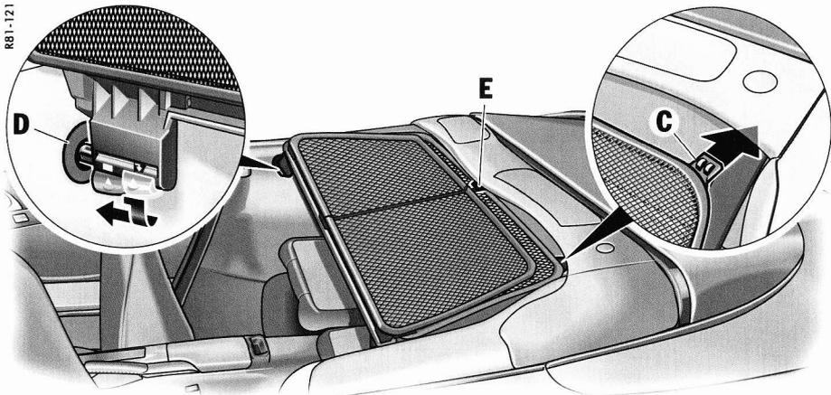
**6.** Introduisez les pattes de fixation **C** du saute-vent dans les guides des ceintures de sécurité. Vérifiez que l'ergot plastique **E** s'engage dans le guide central du saute-vent.
