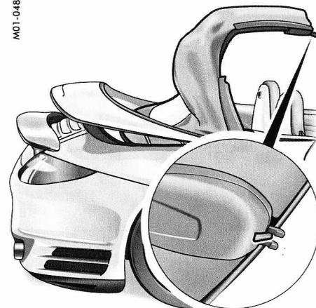
Le système de verrouillage est fixé avec le crochet de verrouillage à la capote. Effectuez les travaux au niveau du verrouillage de capote depuis le côté droit du véhicule.
