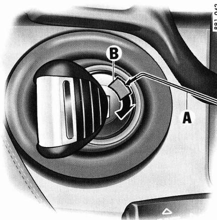
3. À l'aide du crochet métallique **A**, retirez le couvercle en plastique **B** du contacteur d'allumage. Attention de ne pas perdre le couvercle en plastique **B**.
