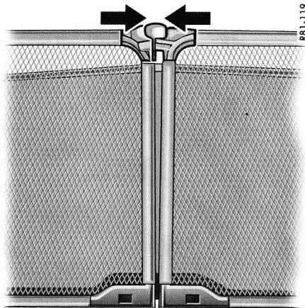
4. Vérifiez que le cran d'arrêt de la partie inférieure du saute-vent est correctement enclenché. Comprimez le cas échéant ce cran d'arrêt (**flèches**).
