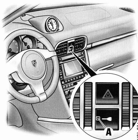
**A** - Diode électroluminescente du système d'alarme
