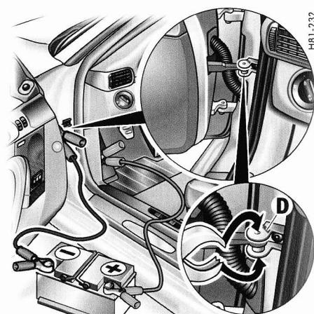
5. À l'aide du câble auxiliaire de démarrage noir, reliez le pôle moins de la batterie extérieure à l'articulation du dispositif d'arrêt de la portière **D**.
