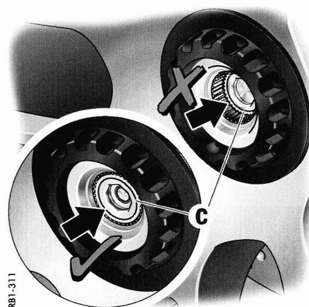
**15.** Retirez la douille intercalaire et vérifiez si le boulon de verrouillage **C** s'est déjà enclenché automatiquement dans la vis centrale. Dans ce cas, il se trouve à fleur de la denture interne de la vis centrale.
