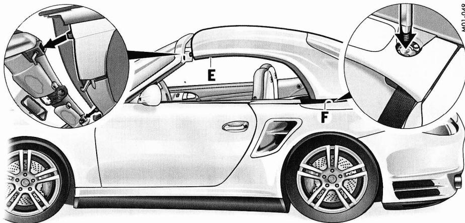
7. Vérifiez si les vis à l'arrière du hard-top sont dévissées (tournez-les de 2 tours vers la droite).
