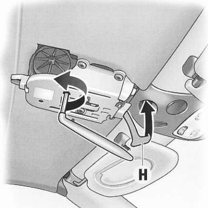
1. Réintroduisez la clé Allen. Tournez-la dans le sens de la flèche «close» jusqu'à ce que vous sentiez une résistance et que la capote soit entièrement verrouillée.
