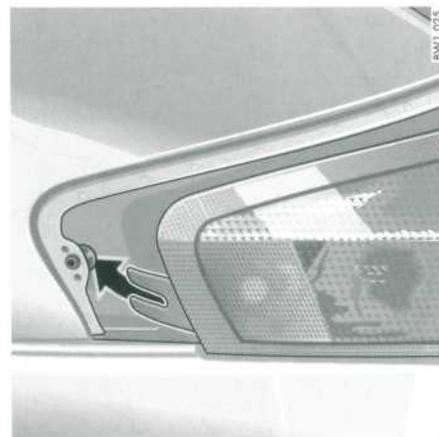
6. Placez le feu arrière dans l'aile en prenant garde de le positionner correctement sur l'ergot de maintien (cf. flèche).
