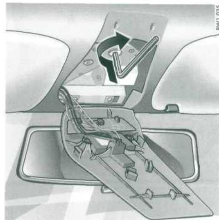
5. Enfoncez la clé Allen dans l'axe de l'entraînement et tournez-la vers la droite jusqu'à ce que le toit ouvrant/coulissant se ferme.
