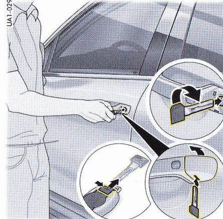
5. Introduisez la clé de secours dans la fente sous la poignée de porte et retirez le cache du support de serrure.
