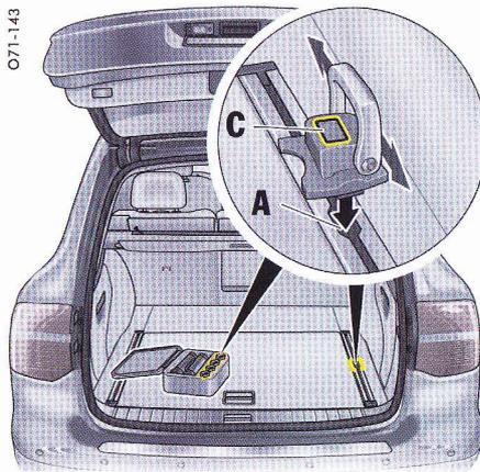
1. Insérez les œillets d'arrimage dans l'orifice **A** du rail de fixation.
