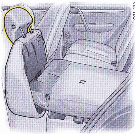
7. Enfoncez l'appui-tête dans le logement du coussin du siège.
