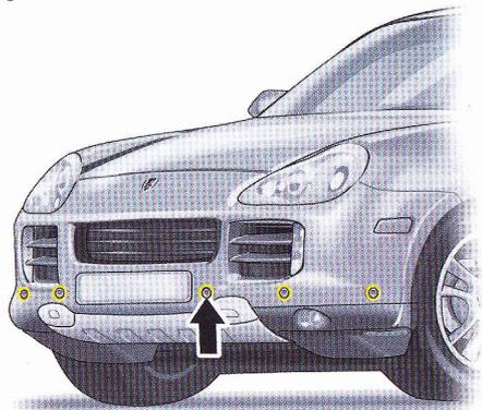
Capteurs à ultrasons avant
