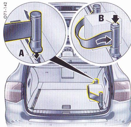
2. Insérez l'un des éléments d'extrémité de l'enrouleur de sangle dans l'orifice **A** de l'un des rails de fixation, appuyez dessus et positionnez-le comme vous le souhaitez.
