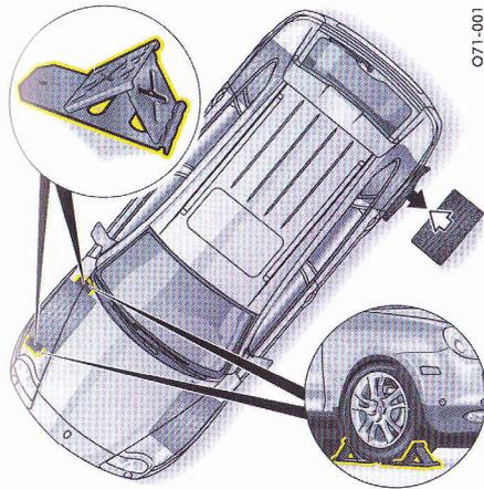
4. Placez les cales directement devant et derrière la roue diamétralement opposée.
