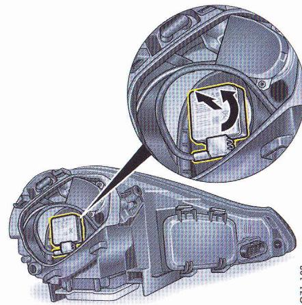
3. Faites tourner l'ampoule à décharge dans le sens inverse des aiguilles d'une montre et retirez-la.
