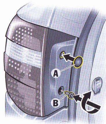
3. Serrez les vis de fixation **B**. Lorsque vous serrez les vis de fixation, veillez à ce que le feu arrière affleure avec la carrosserie.
