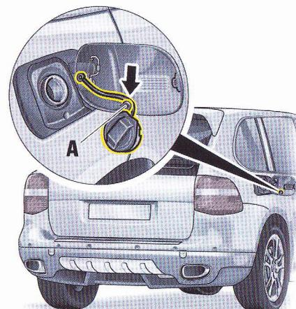
3. Dévissez lentement le bouchon du réservoir. Accrochez-le à l'attache plastique **A** de la trappe du réservoir d'essence.
