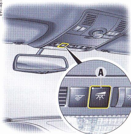
**A** - Variateur de luminosité pour l'éclairage de confort
