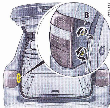
4. Dévissez les deux vis de fixation **B** à l'aide de la clé de l'outillage de bord.
