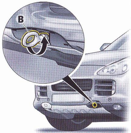
2. Vissez l'œillet de remorquage **B** jusqu'en butée (filetage gauche) et serrez-le à la main.
