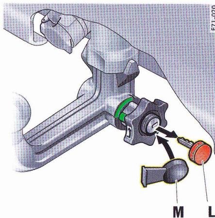
2. Verrouillez le crochet en tournant la clé **L** dans le sens inverse des aiguilles d'une montre et retirez la clé. Après avoir retiré la clé, vous ne devez plus pouvoir tirer le volant sur le côté.
