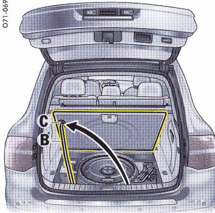
2. Déclipsez la béquille **B** et introduisez-la dans le logement **C** du plancher du coffre.
