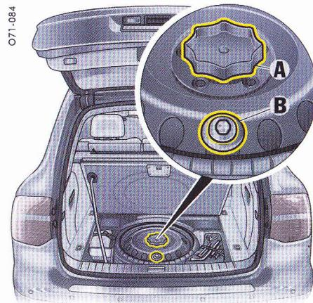
2. Devissez la vis **B** et retirez la roue de secours.
