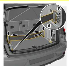
Fig. 73: Positionnement de l'enrouleur de sangle
