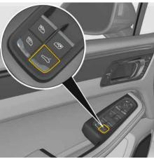
Fig. 117: Touche du hayon arrière dans la porte conducteur
