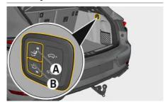
Fig. 96: Escamotage ou déploiement du dispositif d'attelage
