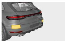
Fig. 6 : Capteurs radar dans le pare-chocs arrière
