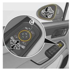
Fig. 187 : Réglage des rétroviseurs extérieurs
