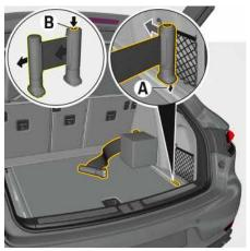
Fig. 74: Montage de l'enrouleur de sangle sur un rail
