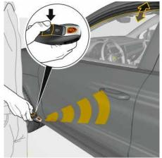
Fig. 237 : Ouverture et fermeture des vitres avec la clé du véhicule
