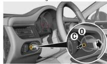
Fig. 46 : Procédure de déverrouillage d'urgence
