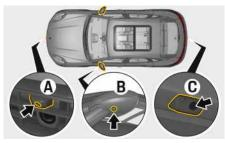
Fig. 15: Emplacement des caméras périphériques
