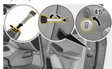
Fig. 235 : Procédure de verrouillage de secours de la porte passager
