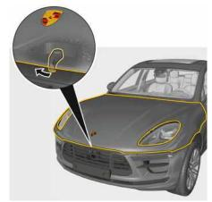
Fig. 30: Ouverture du capot moteur
