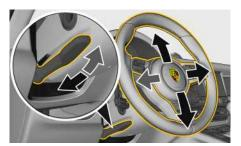
Fig. 241 : Levier d'arrêt de réglage manuel du volant
