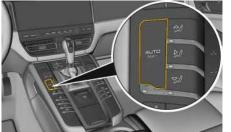
Fig. 55 : Activation et désactivation du mode REST
