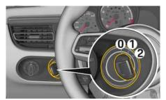
Fig. 93 : Positions de la clé dans le contacteur d'allumage
