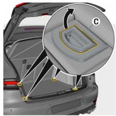
Fig. 70: Utilisation des œillets d'arrimage
