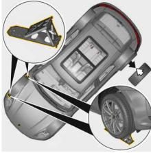
Fig. 91: Positionnement des cales
