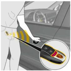
Fig. 230 : Déverrouillage de la porte avec Porsche Entry & Drive
