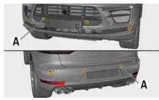
Fig. 12 : Capteurs à ultrasons utilisés pour la mesure de la distance
