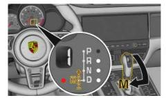
Fig. 25 : Mode de changement de vitesses manuel sur le levier sélecteur
