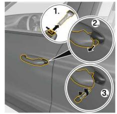
Fig. 234 : Déverrouillage / verrouillage d'urgence de la trappe du réservoir
