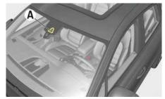
Fig. 100: Position de la caméra
