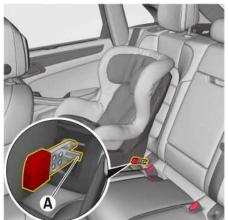
Fig. 219 : Installation d'un système de retenue pour enfants avec pied d'appui
