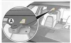
Fig. 19: Caméra avant du pare-brise
