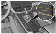
Fig. 165 : Touche de programme de conduite dans la console centrale
