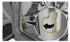
Fig. 29 : Déverrouillage du capot moteur
