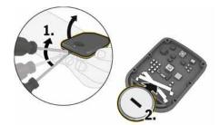
Fig. 159 : Remplacement de la pile de la carte conducteur PVTS Plus
