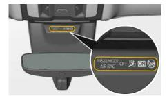
Fig. 210: Indicateur PASSENGER AIR BAG OFF/ON
