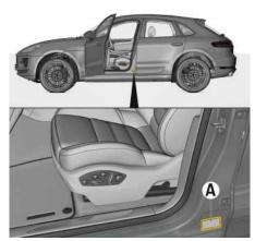
Fig. 132 : Emplacement de la plaque d'indication des pressions de gonflage des pneumatiques
