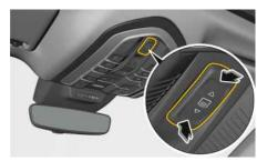
Fig. 201 : Ouverture et fermeture du store de protection solaire
