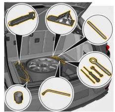
Fig. 63 : Outillage de bord dans des véhicules avec roue de secours de type galette
