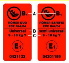
Fig. 213 : Exemple d'autocollant ECE sur un système de retenue pour enfants
