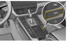
Fig. 168: Touche d'échappement sport dans la console centrale
