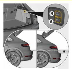
Fig. 142 : Réglage de l'abaissement de l'arrière du véhicule à l'aide des touches situées dans le coffre à bagages
