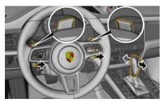
Fig. 26: Volant avec palettes de passage de rapport
