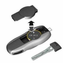
Fig. 43: Remplacement de la pile
