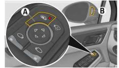
Fig. 5 : Touche A d'activation et de désactivation, affichage B dans le rétroviseur extérieur
