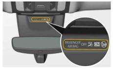
Fig. 217: Indicateur PASSENGER AIR BAG OFF/ON
