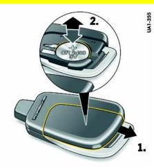
Fig. 35 : Remplacement de la pile de la télécommande
