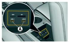
Fig. 2: Interface USB (type C) dans l'accoudoir
