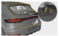
Fig. 116 : Touche de déverrouillage du hayon arrière
