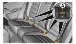
Fig. 218 : Ancrages ISOFIX sur les sièges arrière extérieurs
