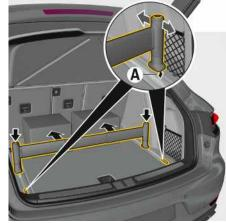
Fig. 71: Utilisation de la barre télescopique
