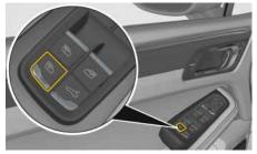
Fig. 239 : Désactivation des touches de commande dans la partie arrière
