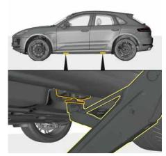
Fig. 89 : Points de logement pour pont élévateur et cric
