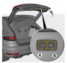
Fig. 118: Touches dans la garniture du hayon arrière
