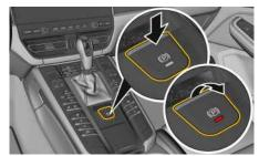
Fig. 112 : Serrage du frein de parking électrique
