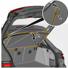
Fig. 65 : Décrochage du couvre-bagages
