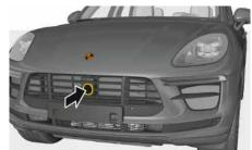
Fig. 175: Position du capteur radar
