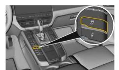
Fig. 156: Touche PSM OFF de la console centrale
