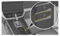
Fig. 56: Activation et désactivation de l'ionisation
