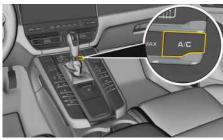
Fig. 49: Activation et désactivation de la fonction de refroidissement
