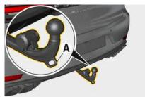
Fig. 97 : Accrochage du câble de retenue dans l'œillet de fixation
