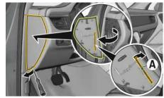
Fig. 44: Extraction du crochet métallique
