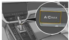
Fig. 50: Activation du refroidissement maximal
