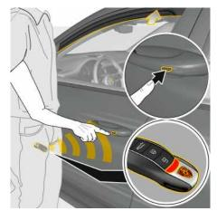
Fig. 238 : Fermeture des vitres à l'aide du détecteur de proximité intégré à la poignée de porte
