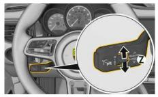
Fig. 178 : Réglage de la distance de régulation
