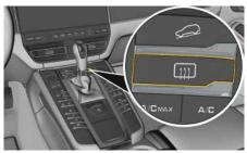
Fig. 58 : Dégivrage de la lunette arrière / des rétroviseurs extérieurs
