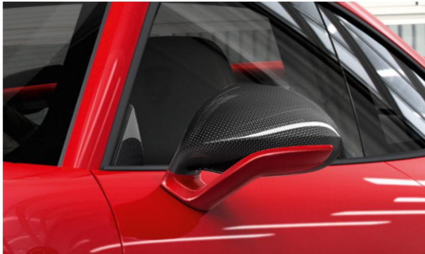
Coque supérieure des rétroviseurs extérieurs SportDesign en Carbone
