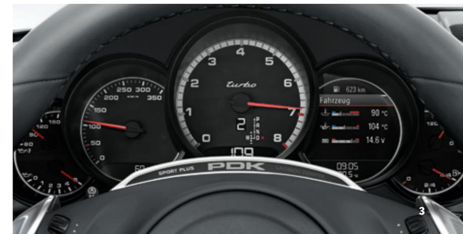
1 Chronomètre numérique et analogique sur le tableau de bord | 2 Touches SPORT sur la console centrale | 3 Affichage au volant avec boîte PDK et Pack Sport Chrono
