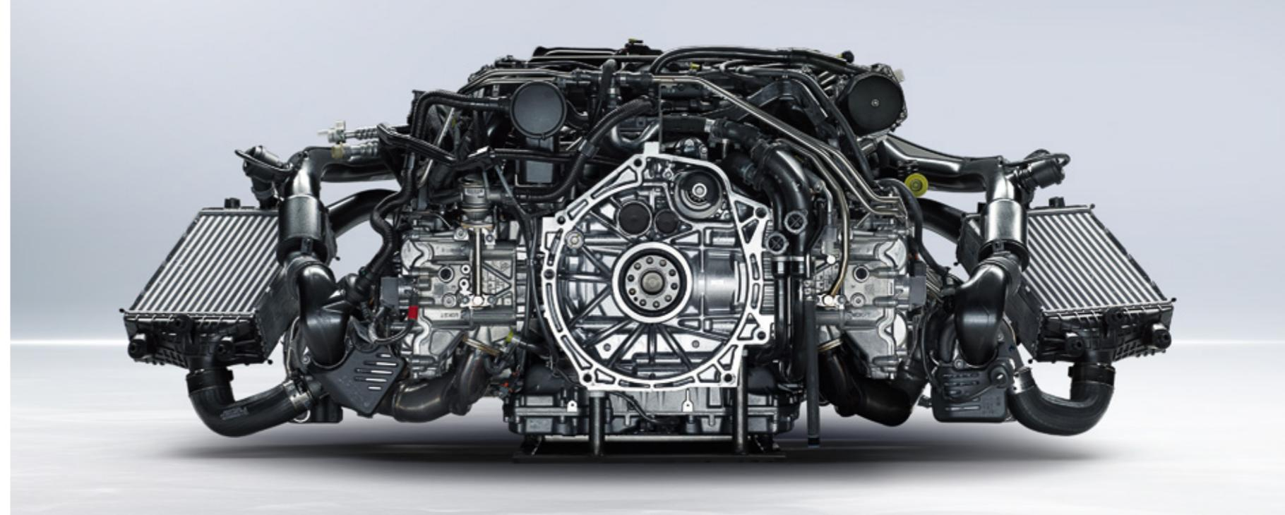
Le flat 6 biturbo de 3,8 litres est en alliage léger. Son faible poids, au regard de sa puissance, améliore l'agilité de la voiture, tout en faisant baisser la consommation. Les bielles sont forgées. Pour encore plus de robustesse, le moteur reçoit des pistons en aluminium forgé,
