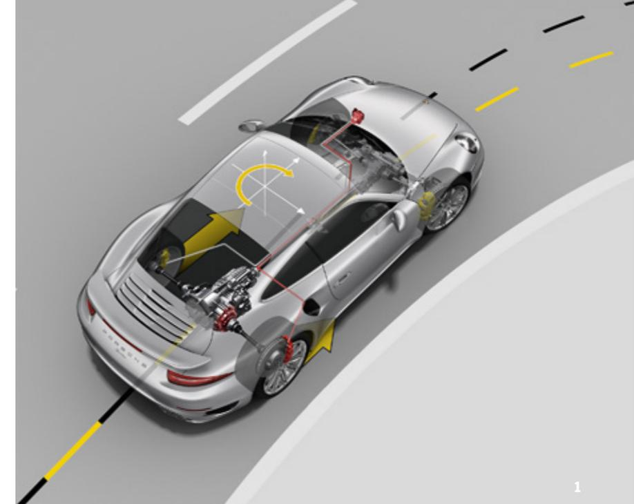
**Porsche Torque Vectoring Plus (PTV Plus), avec différentiel arrière électronique à glissement limité.**
