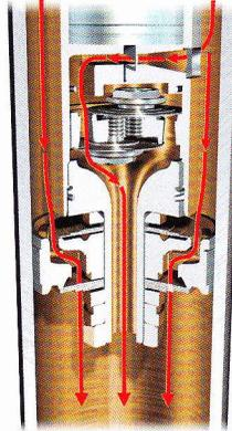
Phase de détente – Piston moteur et
