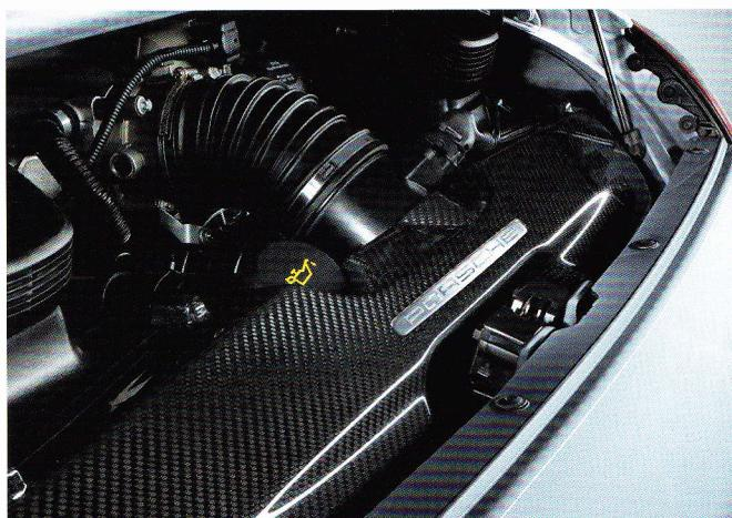
Boîtier de filtre à air en carbone
