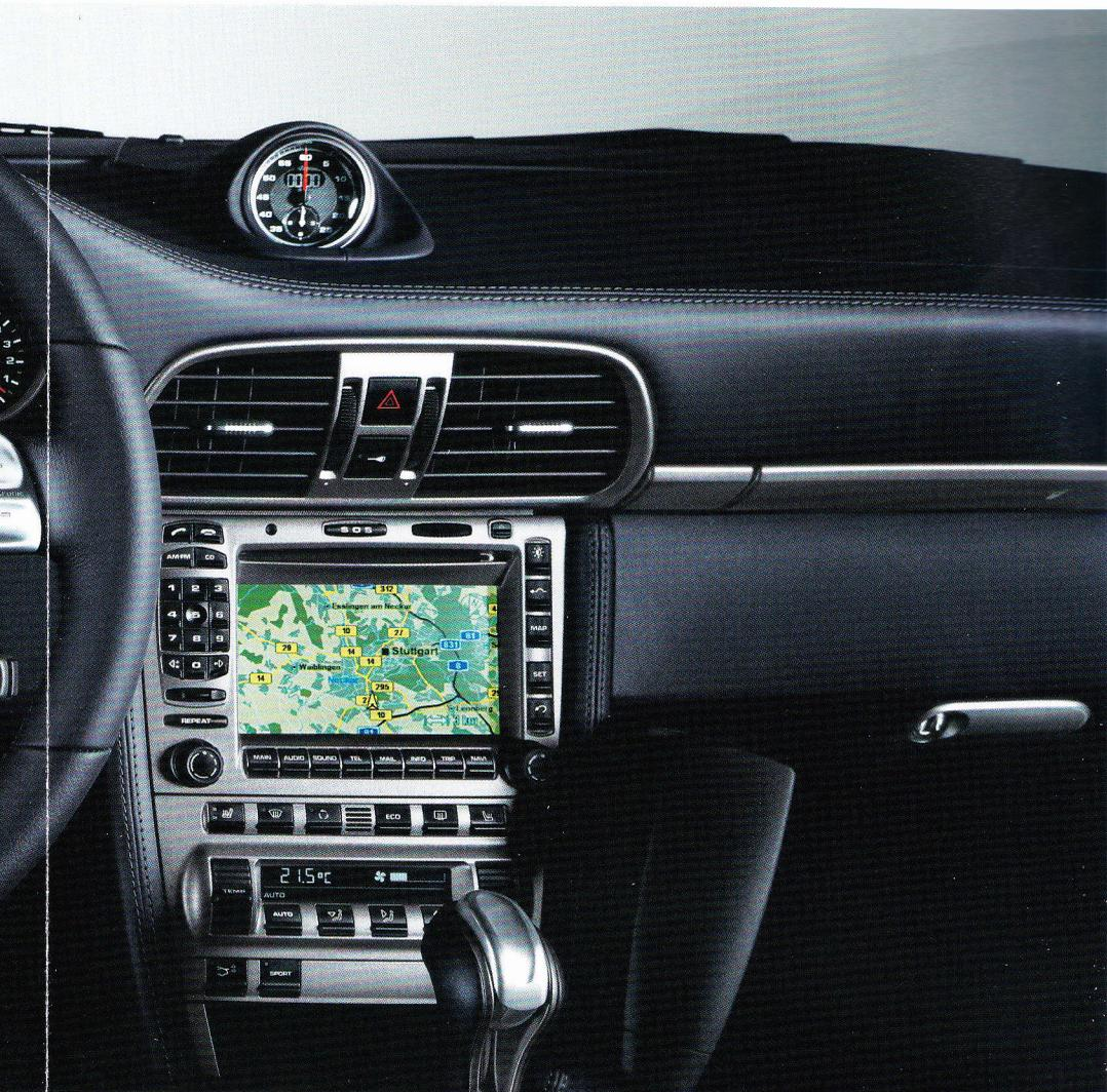
Tableau de bord 911 Carrera/911 Targa 4 et équipements personnalisés : intérieur tout cuir, volant multifonction, Pack Sport Chrono Plus, boîte Tiptronic S, régulateur de vitesse (Tempostat), module de navigation, module de téléphone, combiné passif et système de contrôle de la pression des pneus
