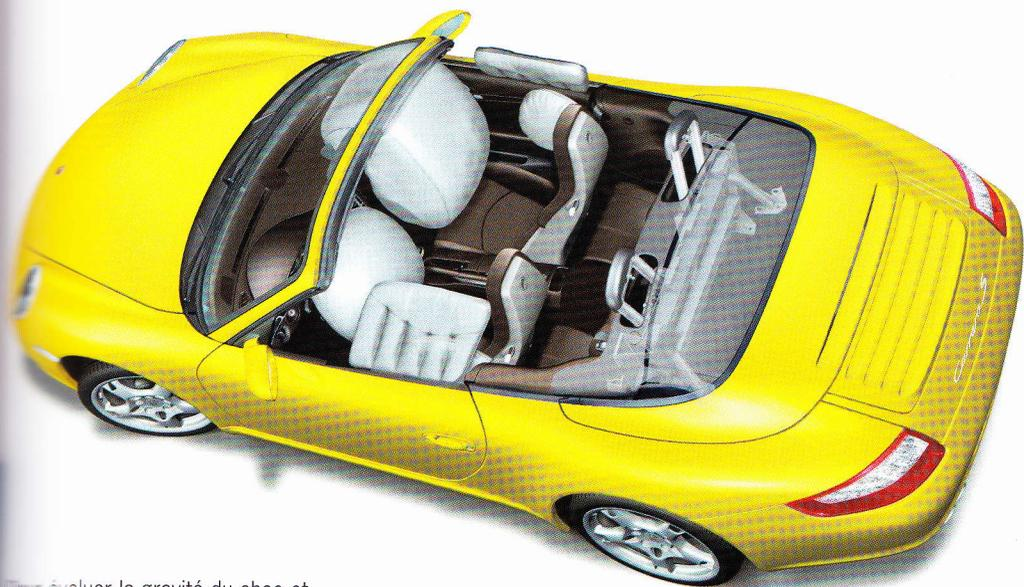
Pour évaluer la gravité du choc et le type de collision, deux capteurs complémentaires intégrés au niveau des phares viennent compléter l'unité centrale sur le tunnel central. Le risque de collision est détecté et évalué à temps.
