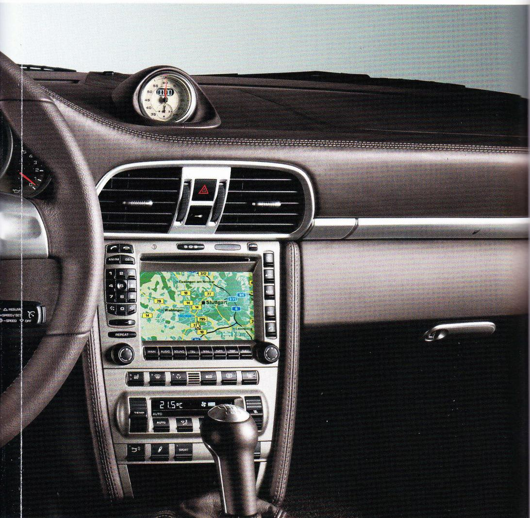
Tableau de bord 911 Carrera S/911 Targa 4S et équipements personnalisés : intérieur tout cuir, Pack Sport Chrono Plus, régulateur de vitesse (Tempostat), module de navigation et système de contrôle de la pression des pneus
