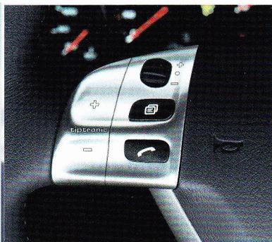
Basculeur Tiptronic S sur le volant
