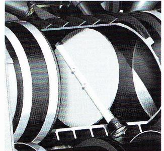
Clapet de réglage dans le système d'admission
