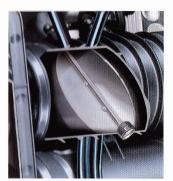
Clapet de réglage dans le système d'admission
