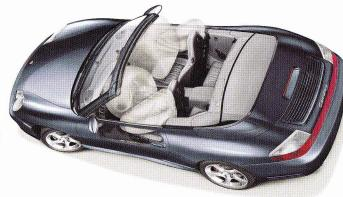
Sur les modèles 911 Cabriolet, la protection des occupants en cas de tonneau est assurée par des montants de pavillon renforcés et
