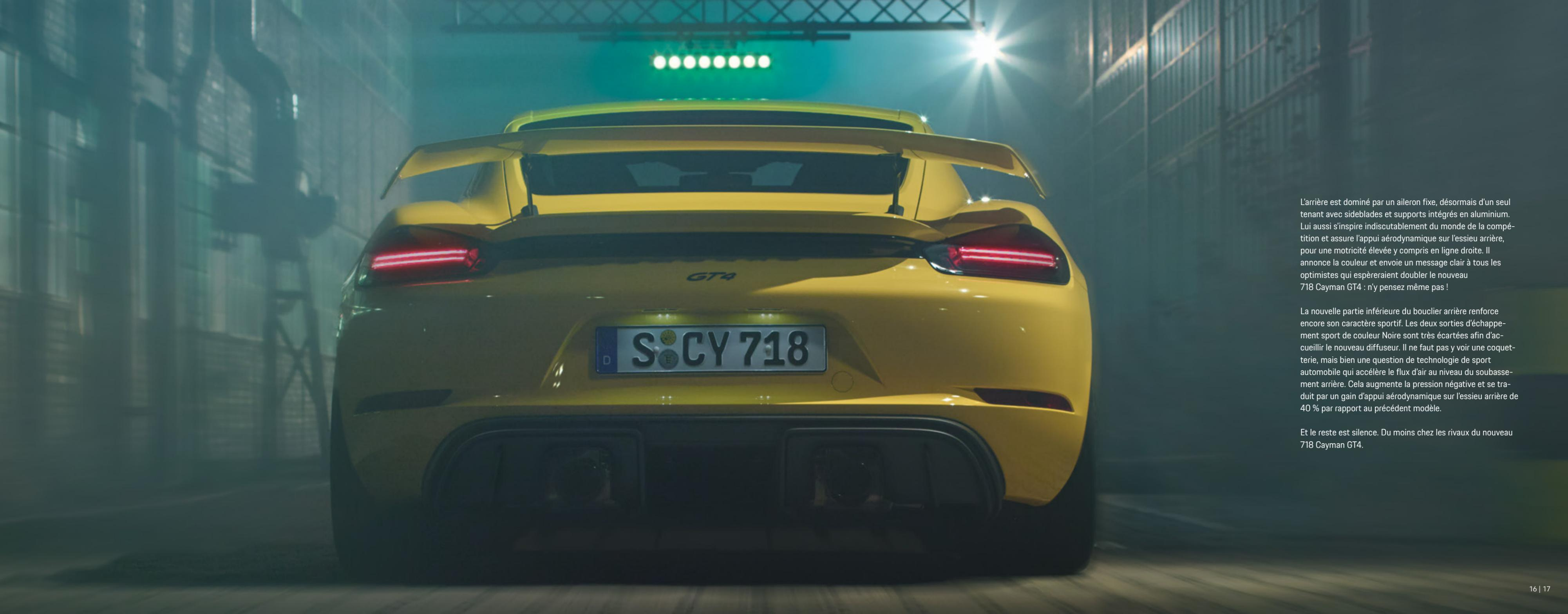
L'arrière est dominé par un aileron fixe, désormais d'un seul tenant avec sideblades et supports intégrés en aluminium. Lui aussi s'inspire indiscutablement du monde de la compétition et assure l'appui aérodynamique sur l'essieu arrière, pour une motricité élevée y compris en ligne droite. Il annonce la couleur et envoie un message clair à tous les optimistes qui espèreraient doubler le nouveau 718 Cayman GT4 : n'y pensez même pas !
