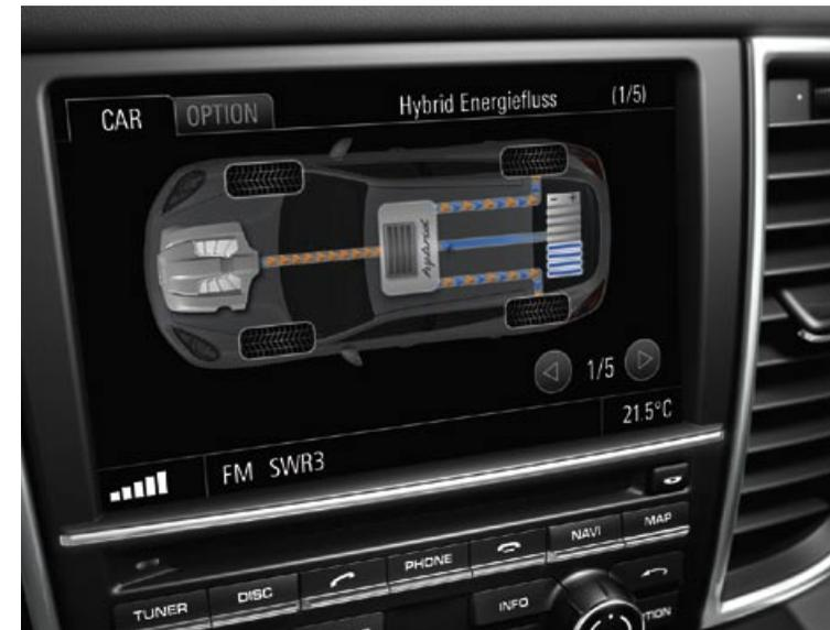
Affichage des flux d'énergie sur le PCM
