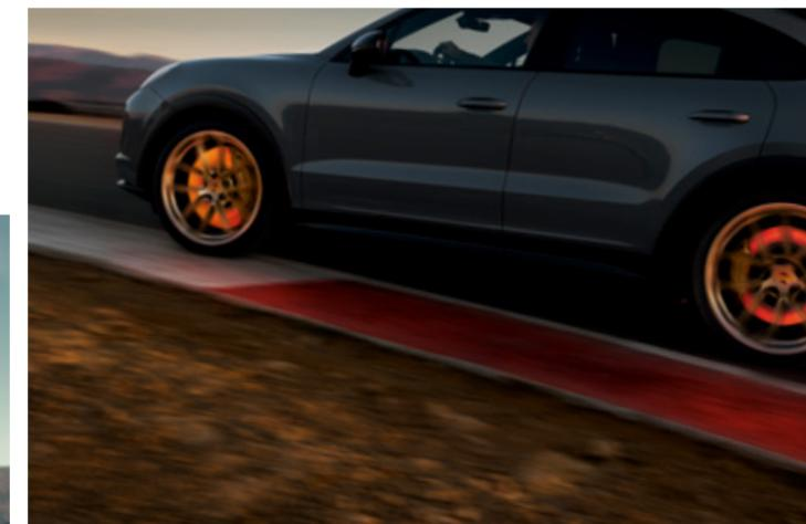
Les **freins Porsche Ceramic Composite Brake (PCCB)** en option offrent une puissance de freinage encore plus élevée grâce à des disques de frein en céramique d'un diamètre de 440 mm sur l'essieu avant et de 410 mm sur l'essieu arrière, sur route ou même en cas d'utilisation continue sur circuit.
