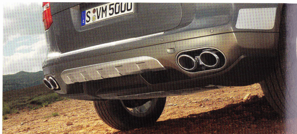
Carter de protection arrière en acier spécial
