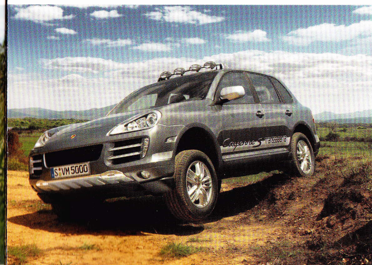
PDCC en mode « Off-road » (tout-terrain) : croisement de pont accru
