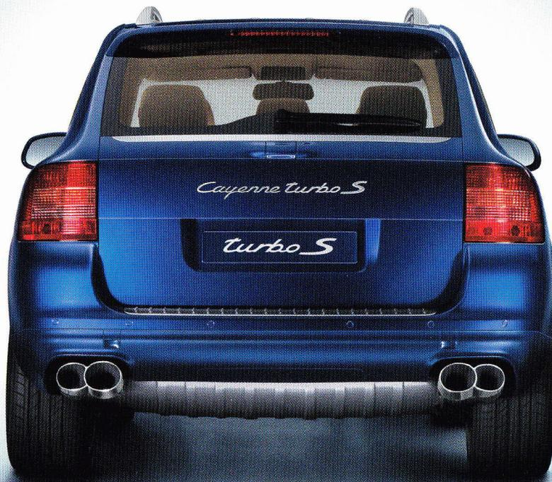
Il affiche une puissance de 521 ch (383 kW), le couple maximal étant disponible à 5 500 tr/min. Par rapport au Cayenne Turbo, le couple a progressé de 100 Nm sur une plage de régime située entre 2 750 et 3 750 tr/min pour atteindre 720 Nm.
