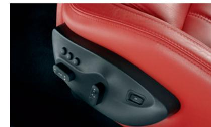
Sièges avant ajustables électriquement
