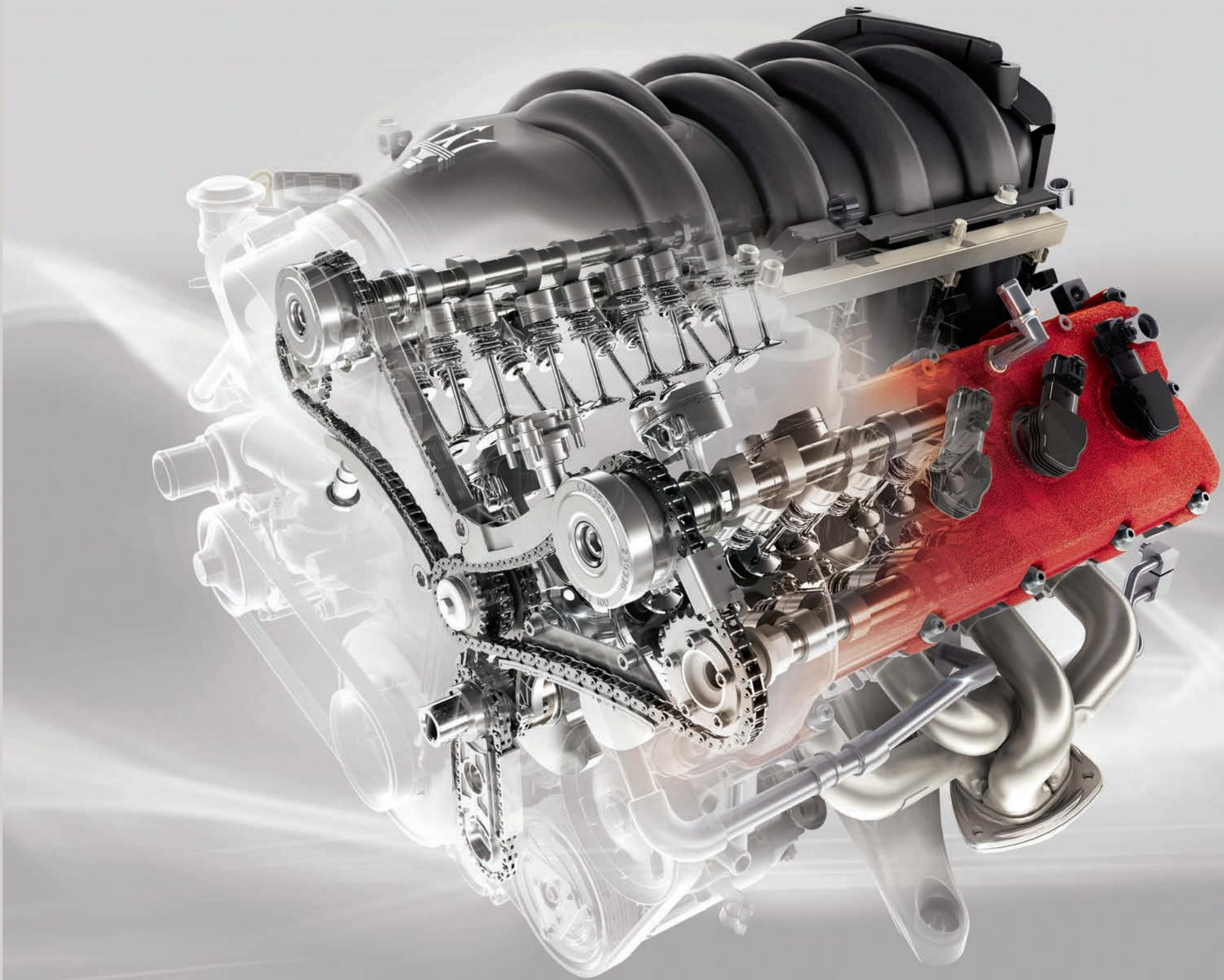
Le moteur, quant à lui, repose sur un système de lubrification par carter humide, où le carter d'huile est solidaire du bloc. Le lubrifiant moteur y est stocké, puis une pompe à bain d'huile le fait circuler. Par conséquent, le moteur est beaucoup plus silencieux, et la conduite plus agréable.
