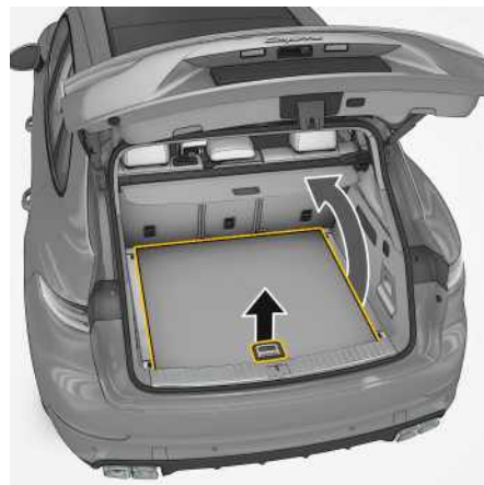
Fig. 54: Ouverture du plancher du coffre
