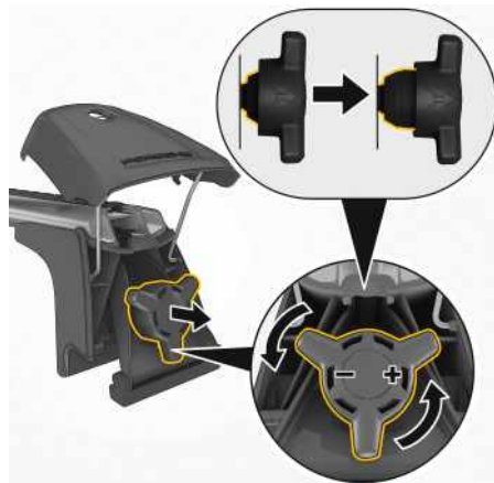
Fig. 191: Retrait d'une vis de fixation et rotation dans le sens inverse des aiguilles d'une montre
