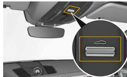
Fig. 185: Ouverture et fermeture du store de protection solaire
