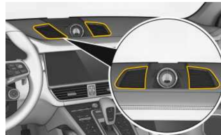
Fig. 46: Zone de ventilation supérieure
