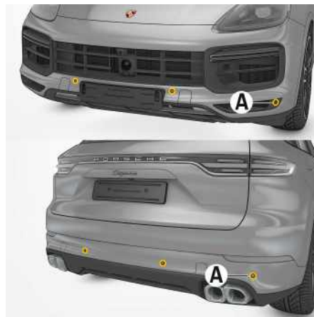
Fig. 15: Capteurs à ultrasons utilisés pour la mesure de la distance
