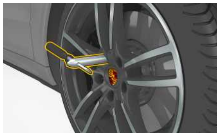
Fig. 124: Vissage d'un auxiliaire de montage sur les véhicules sans PCCB
