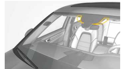
Fig. 115: Fixation des appareils de péage
