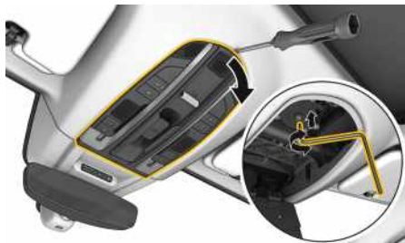
Fig. 187: Actionnement du système de toit à l'aide d'une clé Allen
