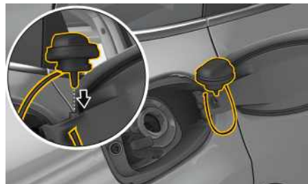
Fig. 156: Ouverture de la trappe du réservoir
