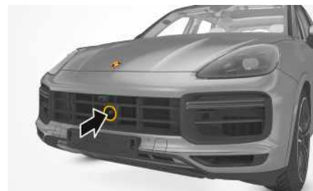
Fig. 160: Position du capteur radar
