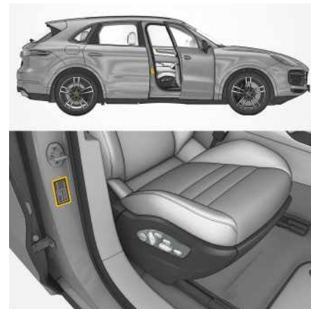
Fig. 230: Emplacement de la plaque signalétique
