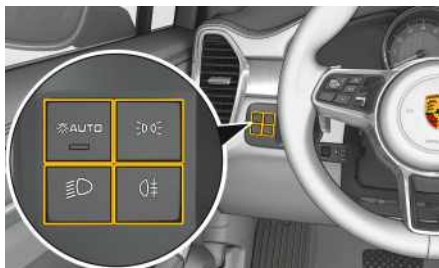
Fig. 86: Panneau de commande de l'éclairage
