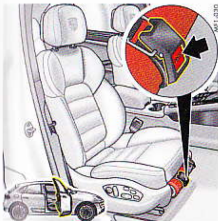
Fig. 118: Extincteur sous le siège passager
