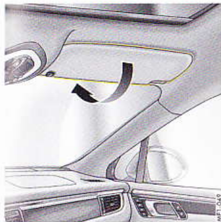
Fig. 168 : Réglage du pare-soleil
