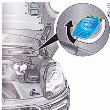
Fig. 154 : Réservoir de liquide lave-glace pour le pare-brise et, le cas échéant, les phares
