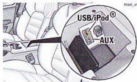
Fig. 213 : Interfaces USB et audio universelle (AUX) sur la console centrale
