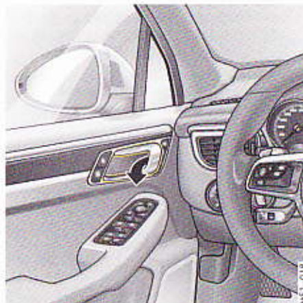
Fig. 303 : Ouverture des portes de l'intérieur
