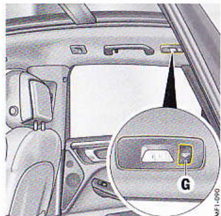
Fig. 126 : Touche de plafonnier ou lampe de lecture arrière
