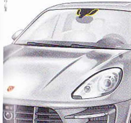
Fig. 6 : Emplacement pour appareils de péage
