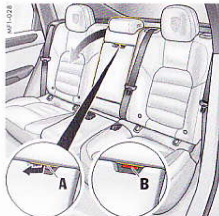
Fig. 258 : Rabattement du dossier du siège arrière du milieu
