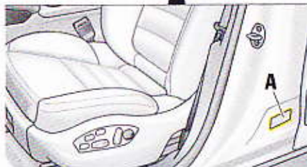
Fig. 192 : Plaque de pression des pneumatiques dans la feuillure de la porte.
