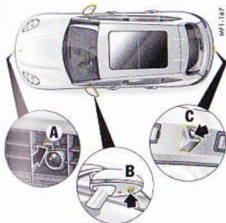
Fig. 24 : Position des caméras périphériques
