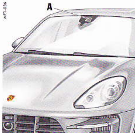
Fig. 3 : Caméra sur le rétroviseur intérieur
