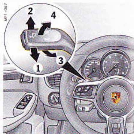
Fig. 122 : Utilisation des leviers de des clignotants et des feux de route
