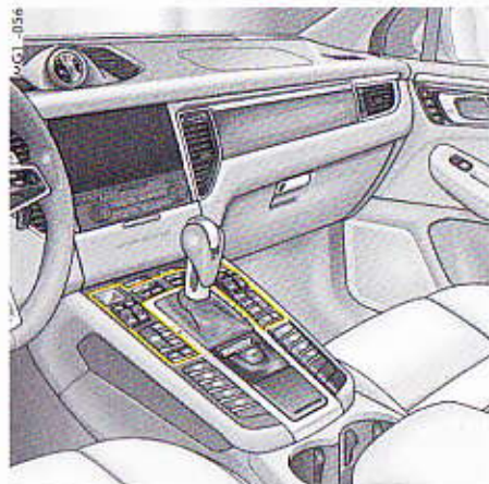
Fig. 58 : Panneau de commande de climatisation avant
