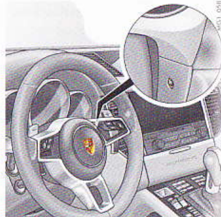
Fig. 60 : Capteur de température de l'habitacle
