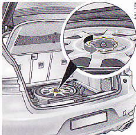
Fig. 102 : Roue de secours de type galette dans le coffre à bagages
