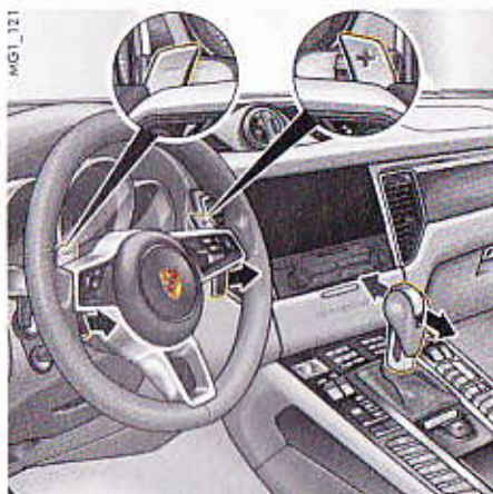
Fig. 36 : Volant équipé de palettes de changement de vitesses
