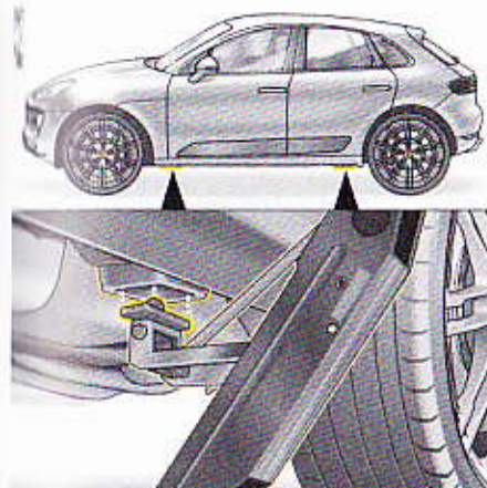
Fig. 103 : Point de logement pour pont élévateur ou cric à l'avant et à l'arrière
