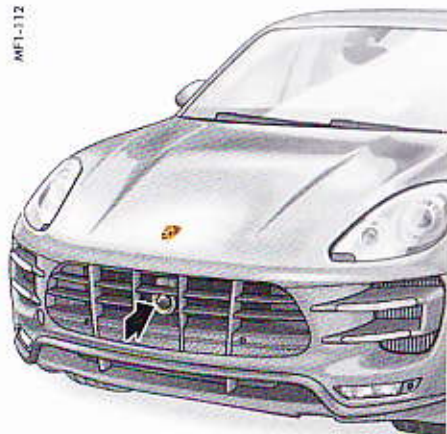
Fig. 237 : Position du capteur radar
