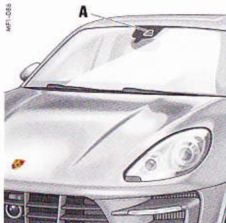
Fig. 28 : Caméra sur le rétroviseur intérieur
