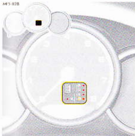
Fig. 34 : Affichage de la position du levier sélecteur et du rapport engagé
