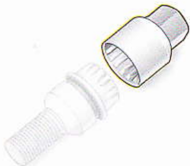
Fig. 197 : Adaptateur pour vis de roue antivol
