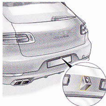
Fig. 23 : Caméra de recul au niveau de l'éclairage de la plaque d'immatriculation dans le pare-chocs
