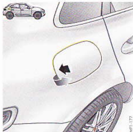
Fig. 227 : Ouverture de la trappe du réservoir
