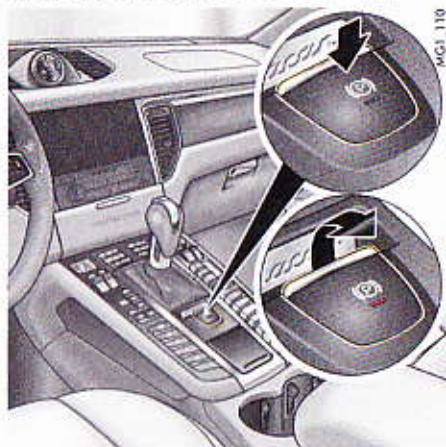
Fig. 135 : Touche du frein de parking électrique
