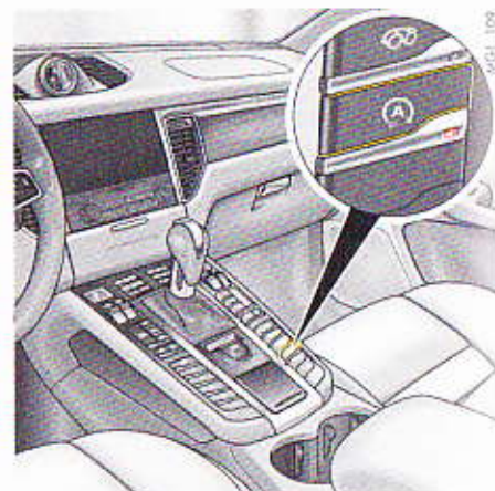
Fig. 134 : Touche de fonction Stop-Start
