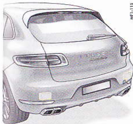
Fig. 14 : Capteurs radar dans le pare-chocs arrière
