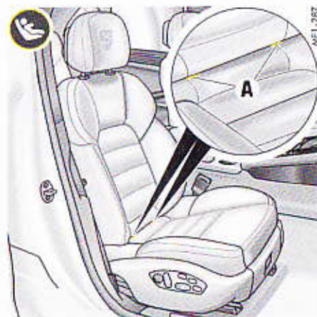
Fig. 283 : Fixation ISOFIX sur le siège passager
