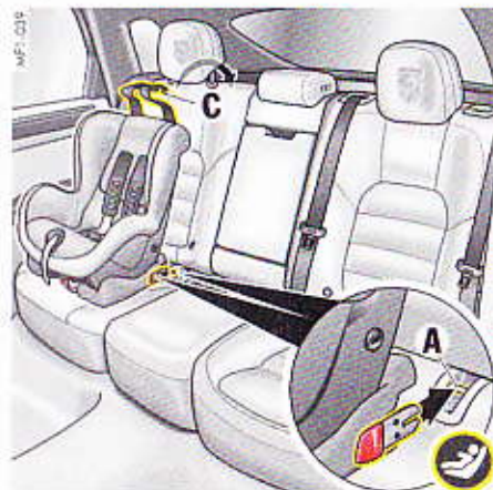
Fig. 286 : Montage des systèmes de retenue pour enfants avec fixation ISOFIX sur le siège arrière
