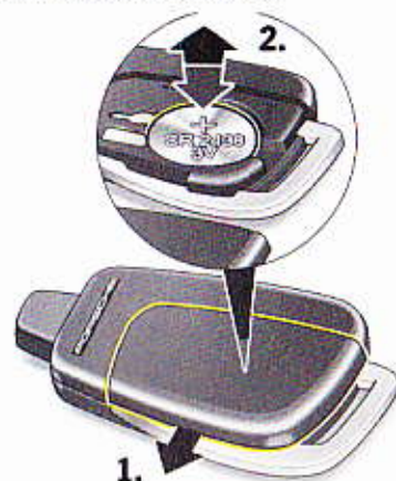
Fig. 47 : Remplacement de la pile de la télécommande
