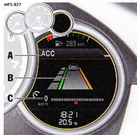
Fig. 5 : Affichage de l'alerte de franchissement de ligne
