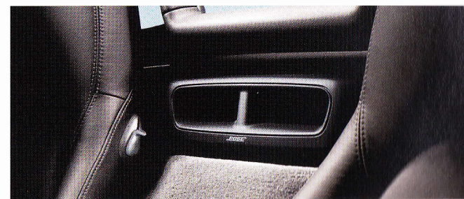
Subwoofer actif avec respectivement 2 HP 13,0 cm pour les graves et 2 HP 6,5 cm médium-aiguës
