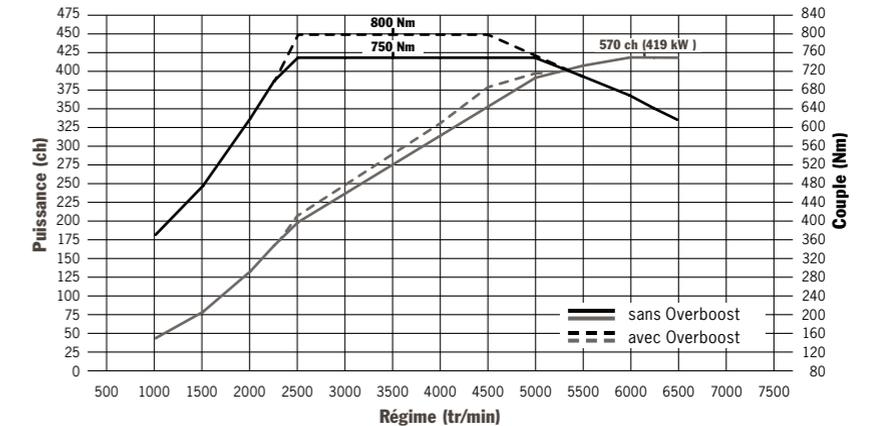
Panamera Turbo S : 570 ch (419 kW) à 6 000 tr/min, 750 Nm entre 2 500 et 5 000 tr/min (800 Nm avec fonction Overboost)
