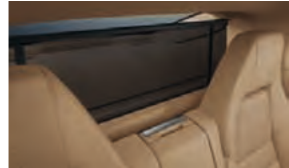
Couvre-bagages rigide avec rideau pare-soleil électrique à l'arrière
