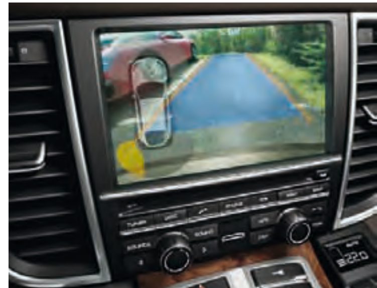
Image projetée par la caméra de recul sur l'écran du PCM
