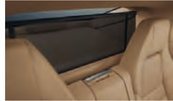
Couvre-bagages souple avec rideau pare-soleil électrique à l'arrière
