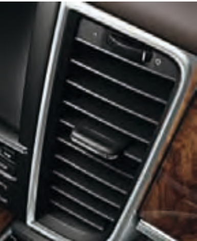
Sorties d'air sur la console centrale
