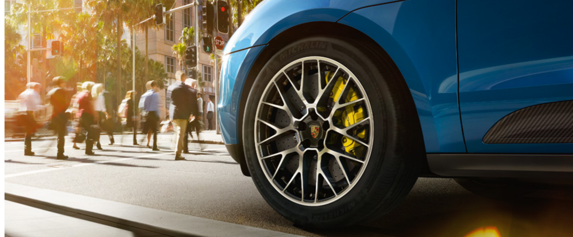
Freins céramique PCCB (Porsche Ceramic Composite Brake) du Macan S
