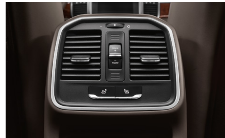
Boutons de commandes arrière pour climatisation automatique 3 zones
